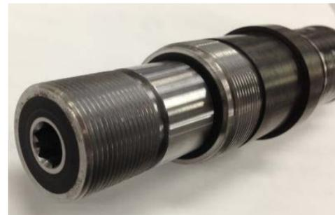
図10 低熱膨張率スピンドルシャフト<sup>7)</sup>
